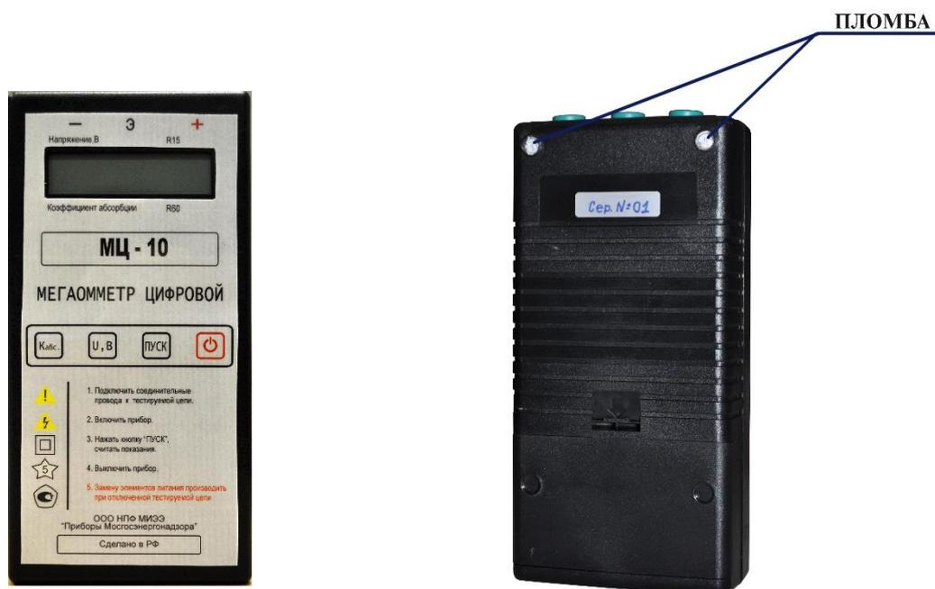
В верхней торцевой части корпуса размещены гнезда подключения измерительных кабелей. На лицевой панели расположен ЖК-дисплей и кнопки управления.
