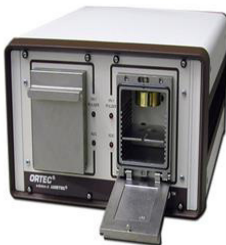
Рисунок 4 – Alpha Duo – двухкамерный альфа-спектрометр
