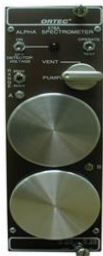
Рисунок 1 – 576А– двухкамерный альфа-спектрометрический блок в стандарте NIM
