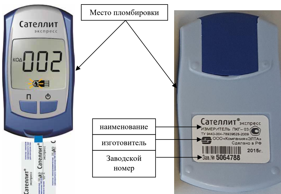
Рисунок 2 – Схемы пломбировки от несанкционированного доступа и маркировки
