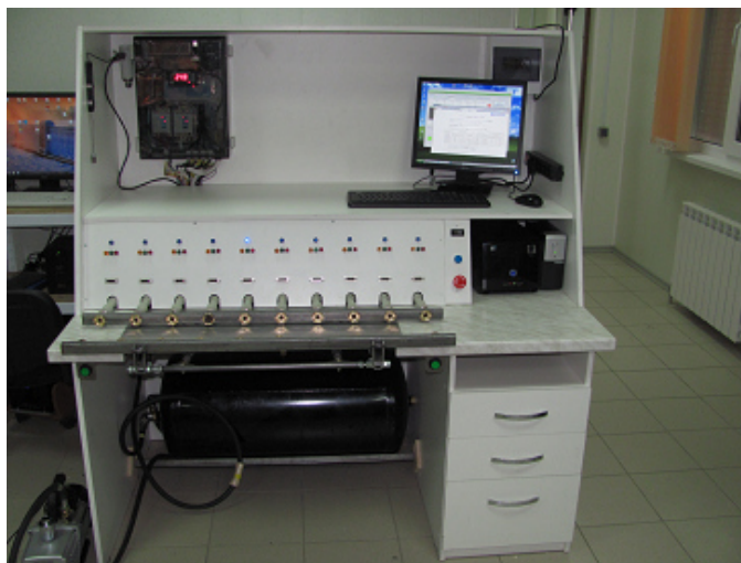
Рисунок 1 – СПУ-5-Х-1 Установка с десятью одновременно подключаемыми счетчиками
