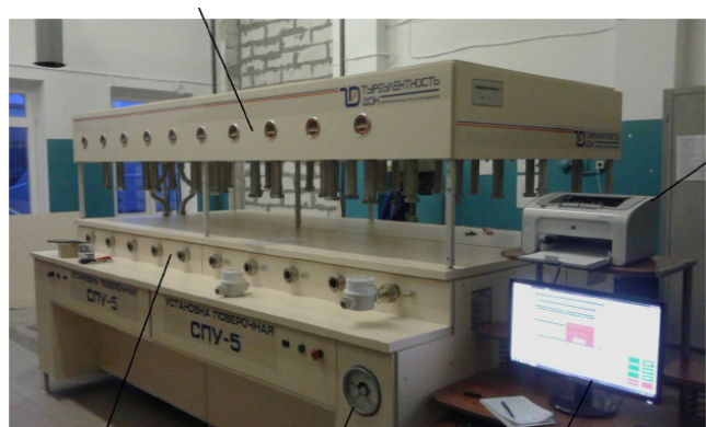
Рисунок 4 – СПУ-5-Х-3 Установка с тридцатью одновременно подключаемыми счетчиками
