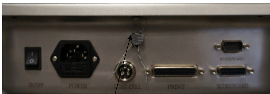
Рисунок 7 – Схема пломбировки от несанкционированного доступа и обозначение места нанесения знака поверки индикатора CTT-SWIFT
