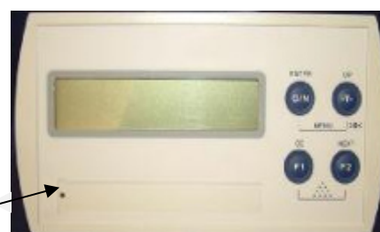
Рисунок 8 – Схема пломбировки от несанкционированного доступа и обозначение места нанесения знака поверки индикатора CTT-DIGITAL
