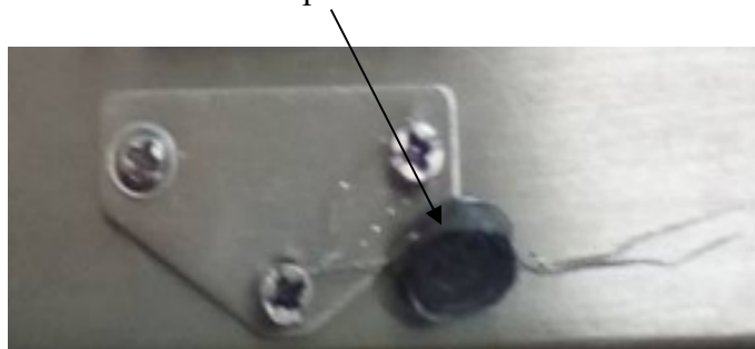
Рисунок 3 – Схема пломбировки от несанкционированного доступа и обозначение места нанесения знака поверки индикатора СТТ-А
