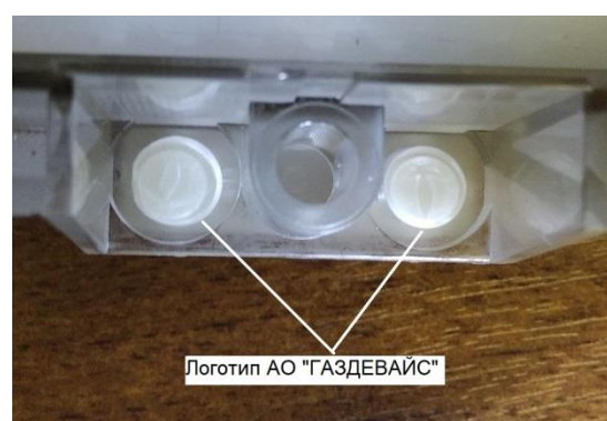
Рисунок 5 – Маркировка нанесена на корпус сумматора
