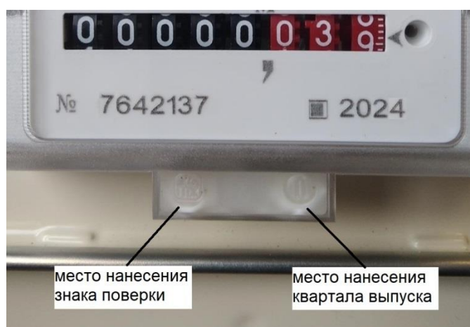
Рисунок 4 – Маркировка нанесена на табличку
