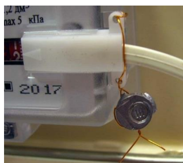
Рисунок 8 – Место пломбирования датчика импульсов
