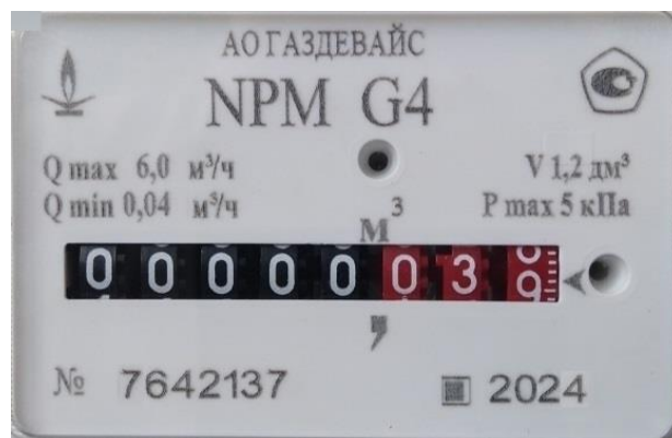
Рисунок 5 – Маркировка нанесена на корпус сумматора
