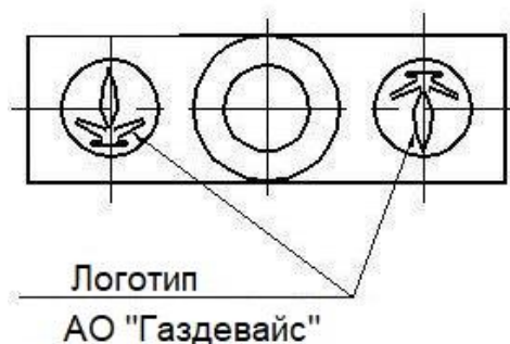
Рисунок 7 – Пломбирование от несанкционированного доступа, обозначение мест нанесения логотипа АО «Газдевайс». Обратная сторона пломбы
