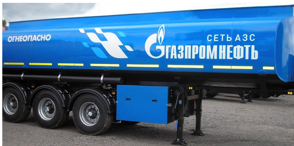
Рисунок 1 – Общий вид полуприцепа-цистерны ППЦ модификации ППЦ-30
