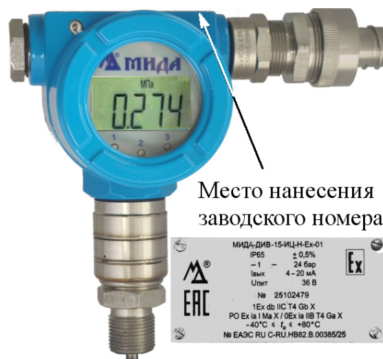
Рисунок 8 – Общий вид датчика МИДА-ДИ (ДА, ДИВ, ДВ)-15-ИЦ-(Н)-Ex d
