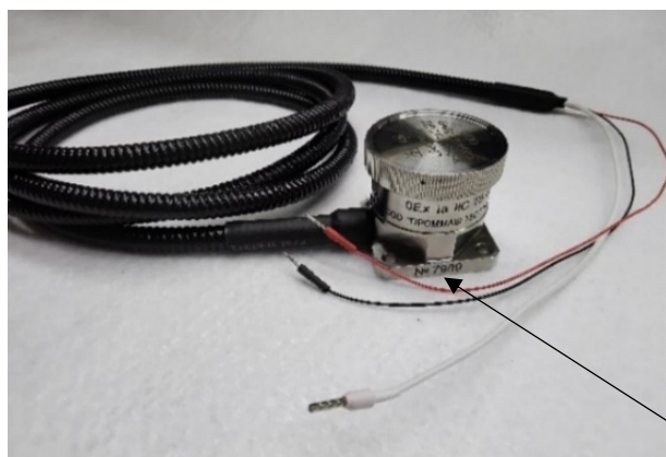
а) Датчики виброскорости с токовым выходом ДВСТ-1
