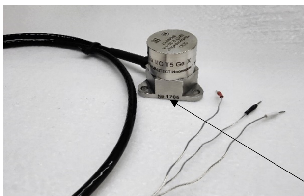
а) Датчики виброскорости с токовым выходом ДВСТ-1
