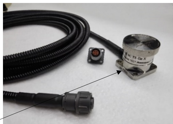
а) Датчики виброскорости с токовым выходом ДВСТ-1
