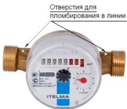
Рисунок 1 – Внешний вид и места пломбирования счетчиков
