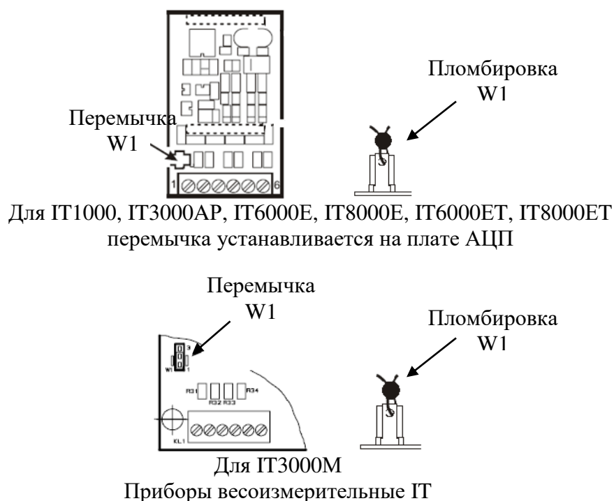
Рисунок 4 – Схема пломбировки электронных весоизмерительных устройств
