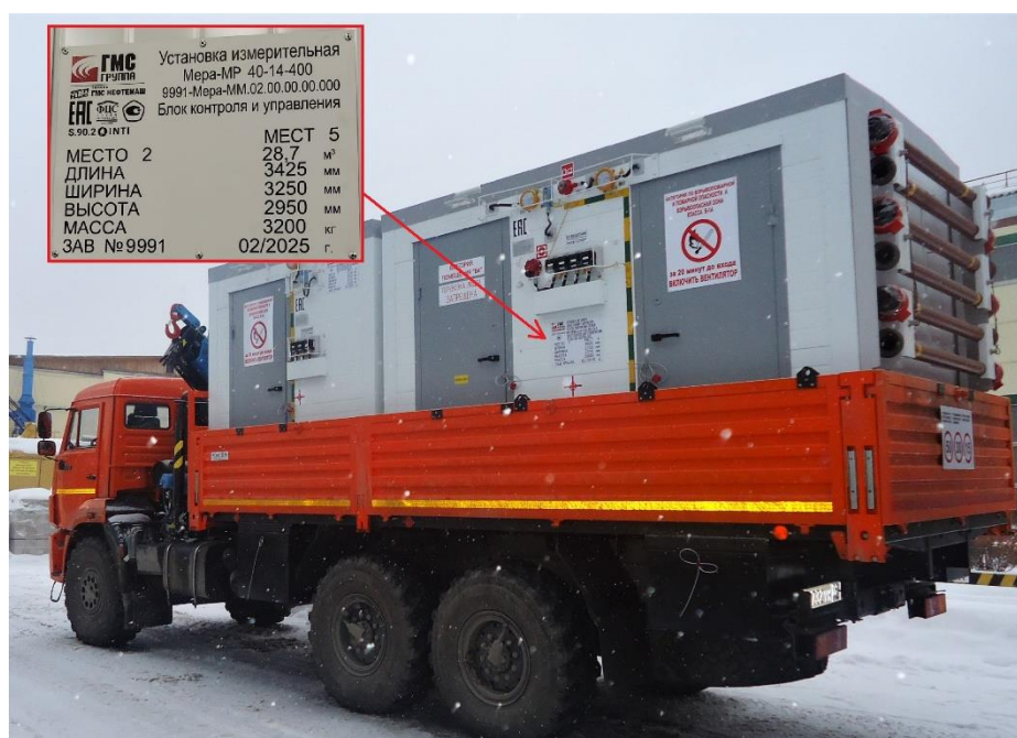
Рисунок 1 – Установка измерительная «Мера-МР». Общий вид. Место нанесения заводского номера
