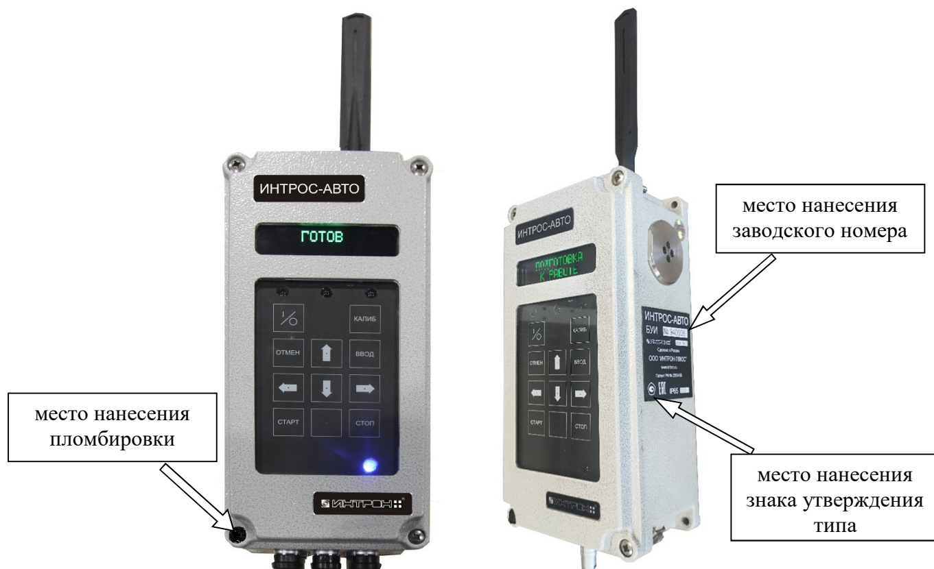
Рисунок 1 – Общий вид блока управления и индикации (БУИ) дефектоскопов, место нанесения знака утверждения типа и место нанесения пломбировки
