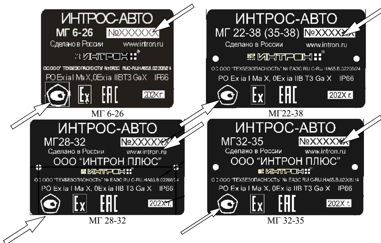
Рисунок 4 – Место нанесения заводского номера и знака утверждения типа на магнитные головки МГ
