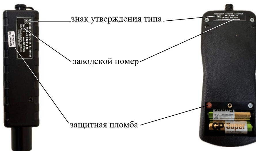
Рисунок 2 – Места нанесения заводского номера, знака утверждения типа и пломбирования от несанкционированного доступа
