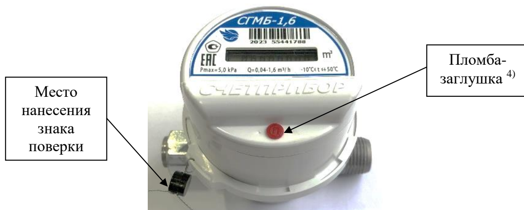
Рисунок 2 – Схема пломбирования и места нанесения знака поверки на корпус средства измерений
