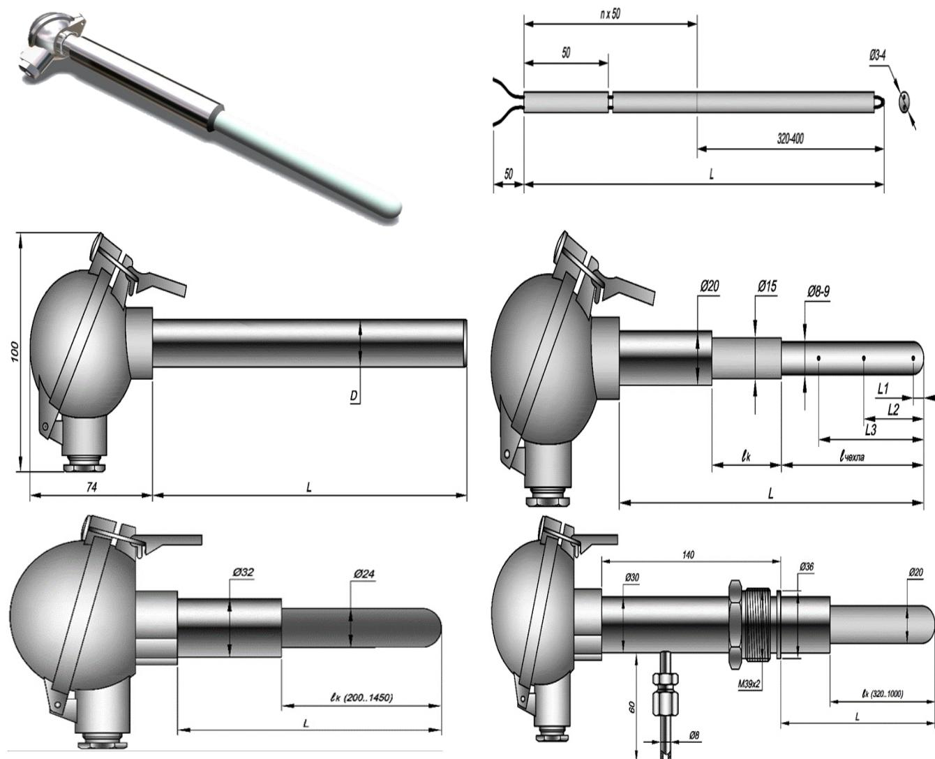
Рисунок 1 – Датчики температуры ТППТ, ТПРТ, ТПВР, ТППТ Ex, ТПРТ Ex
