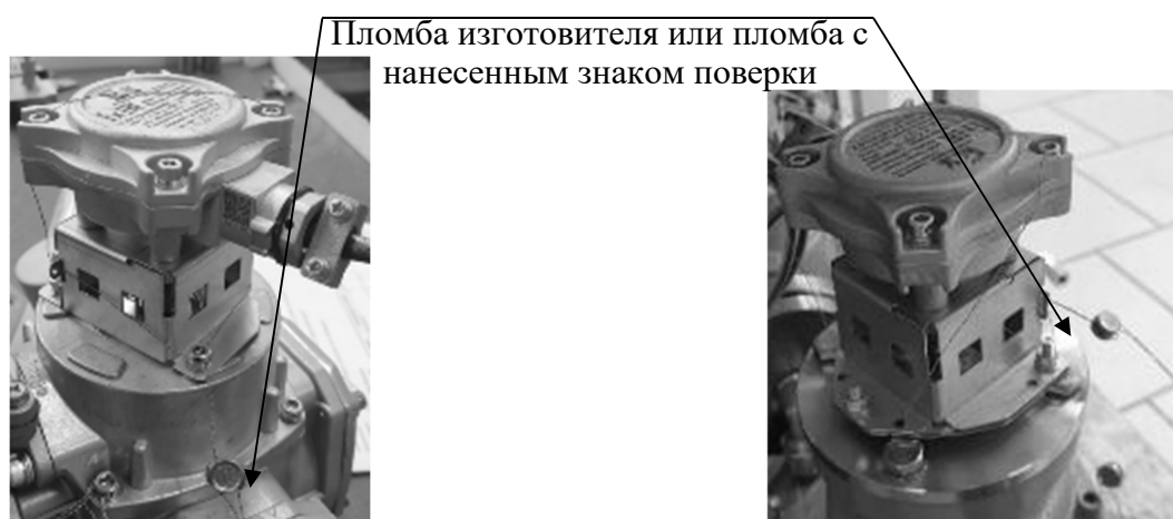
Рисунок 12 – Схемы пломбировки генераторов импульсов
