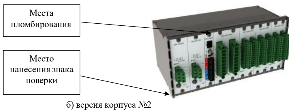
Рисунок 1 – Общий вид крейтового исполнения устройств depRTU
