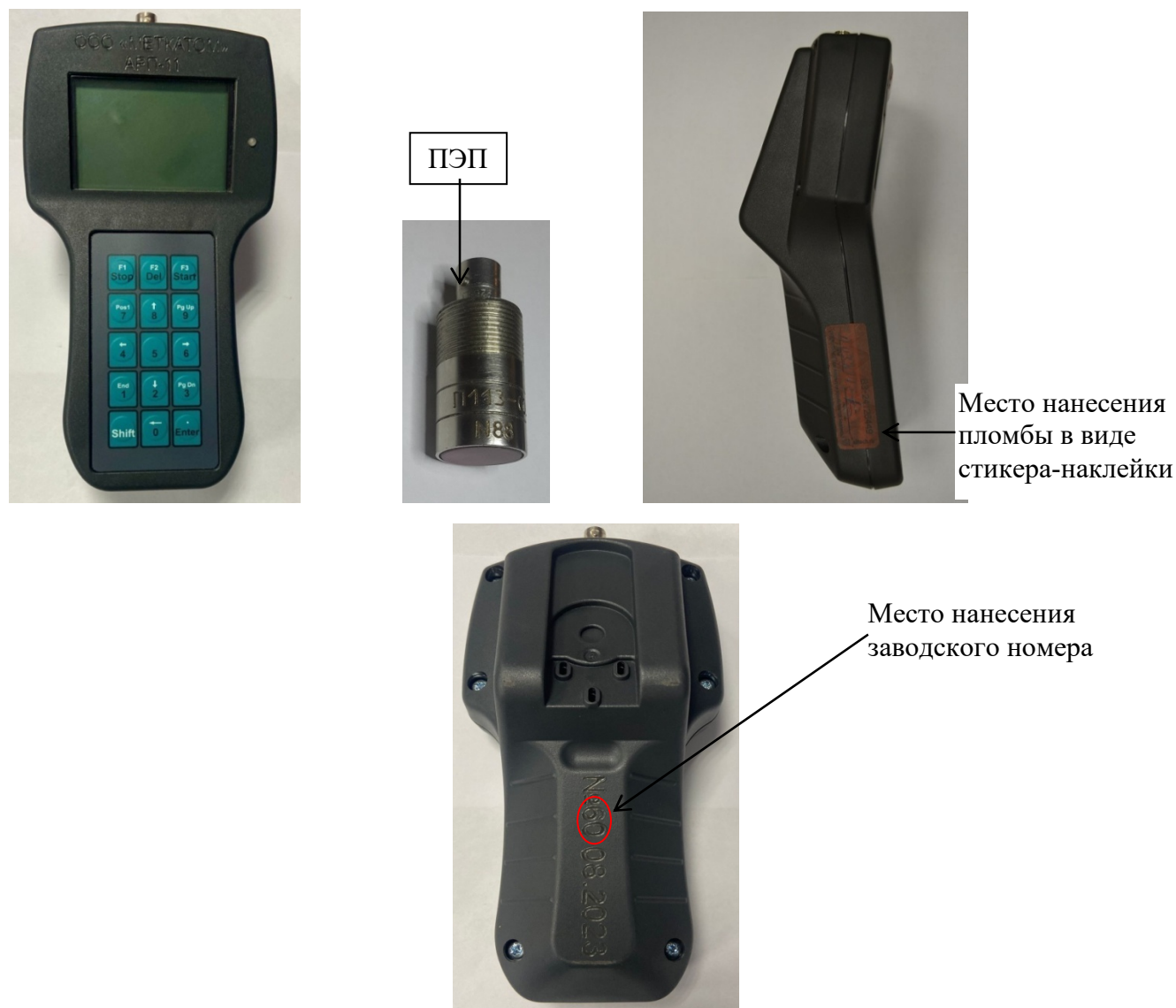
Рисунок 1 – Внешний вид измерителя амплитуд сигналов акустической эмиссии для диагностики и анализа ресурса редукторов и подшипников типа АРП-11/1с указанием места нанесения пломбы в виде стикера-наклейки и места нанесения заводского номера
