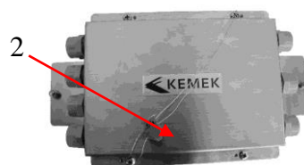
Рисунок 8 – Схема пломбировки соединительной коробки
