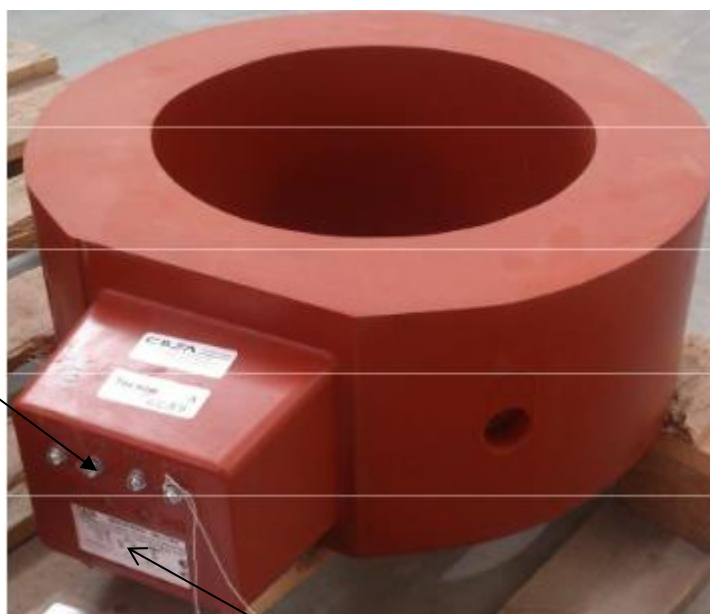
Место нанесения знака утверждения типа и заводского номера (таблички технических данных в виде шильда)
