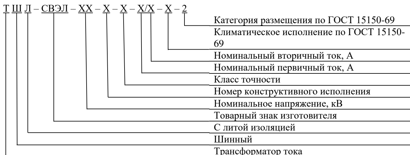
Рисунок 4 – Структура условного обозначения трансформаторов тока ТШЛ-СВЭЛ
