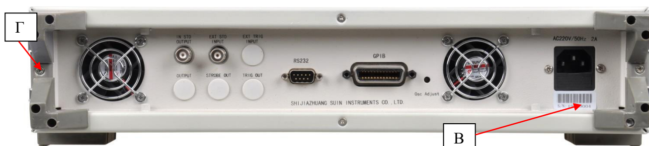
Рисунок 8 – Схемы нанесения заводского номера (В) и пломбировки от несанкционированного доступа (Г) генератора модификации АКИП-3307
