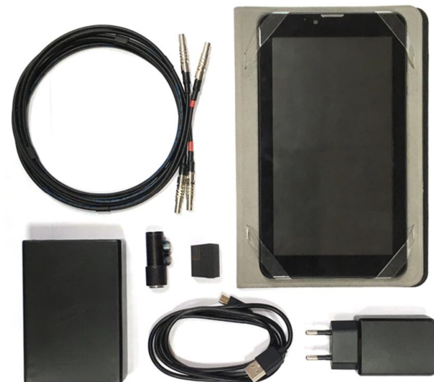
Рисунок 1 – Общий вид дефектоскопов ультразвуковых «Velograph II»
