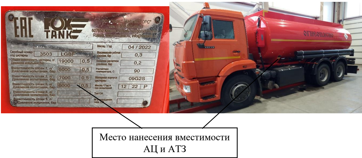
Рисунок 5 – Место расположения таблички с указанием вместимости АЦ и АТЗ
