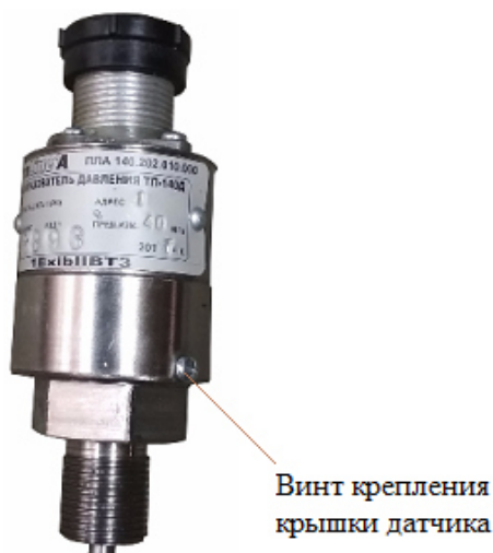
Рисунок 8 – Схема пломбирования преобразователей от несанкционированного доступа
