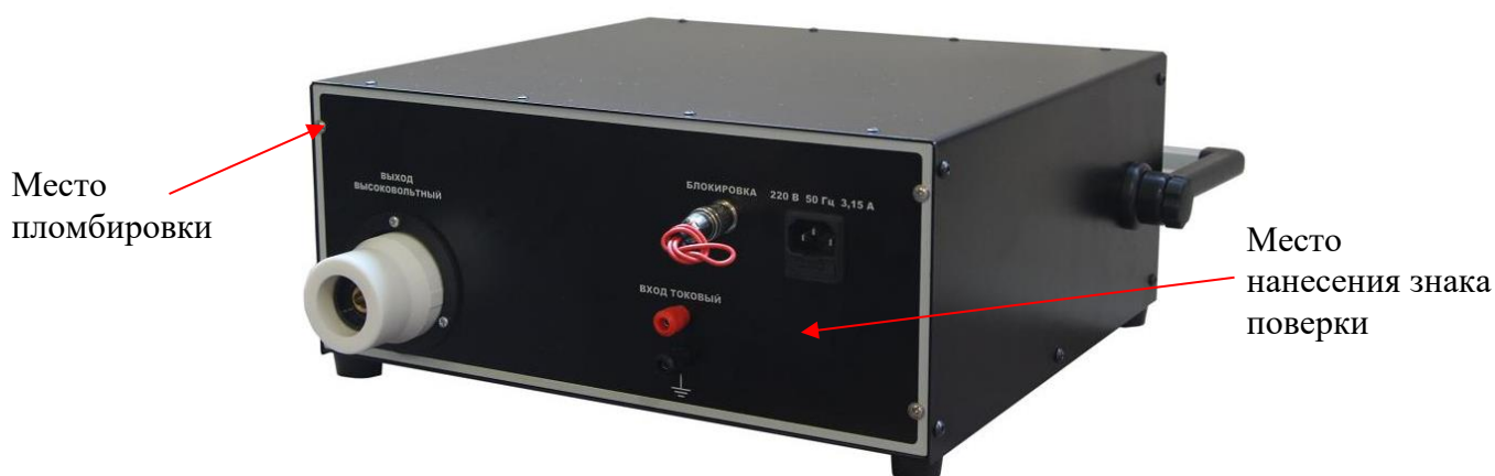
Рисунок 2 – Место пломбировки от несанкционированного доступа и нанесения знака поверки
