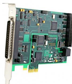
Рисунок 5 – Внешний вид преобразователей модификации L-502 (пломбирование не предусмотрено)
