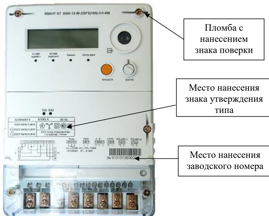
Рисунок 1 – Общий вид счетчика непосредственного включения в исполнении корпуса типа W с указанием места ограничения доступа к местам настройки (регулировки), места нанесения знака утверждения типа, места нанесения заводского номера
