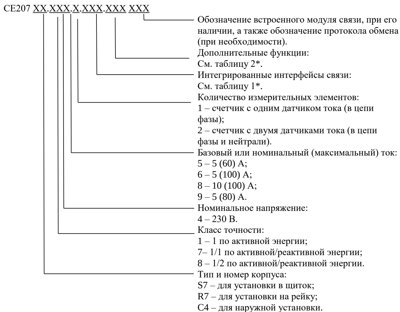
Рисунок 1 – Структура условного обозначения счетчиков
