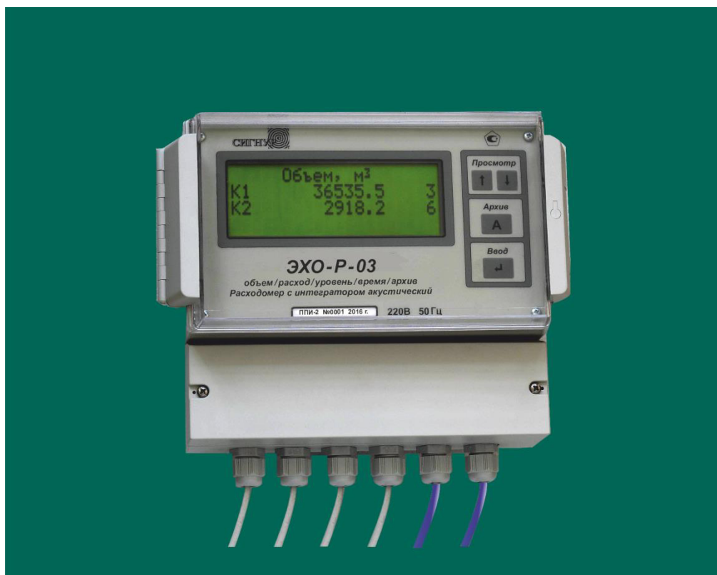
Рисунок 2 – преобразователь передающий измерительный ППИ-2 с маркировочной табличкой
