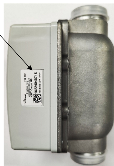
Рисунок 26 – Место нанесения заводского номера и знака утверждения типа
