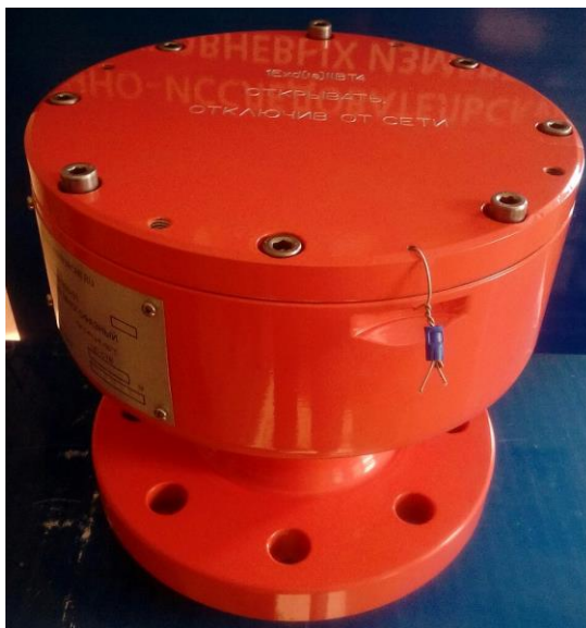
Рисунок 3 – Место пломбировки уровнемеров многофазных серии УМФ300
