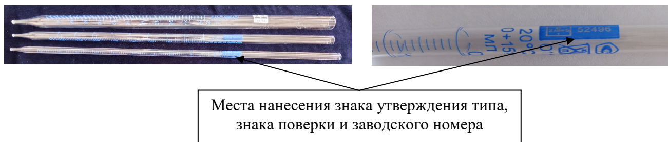
Рисунок 1 – Общий вид пипеток 1-го и 2-го класса точности градуированных исполнение 1 с местами нанесения знака утверждения типа, знака поверки и заводского номера
