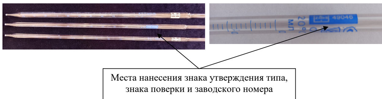
Рисунок 2 – Общий вид пипеток 1-го и 2-го класса точности градуированных исполнение 2 с местами нанесения знака утверждения типа, знака поверки и заводского номера
