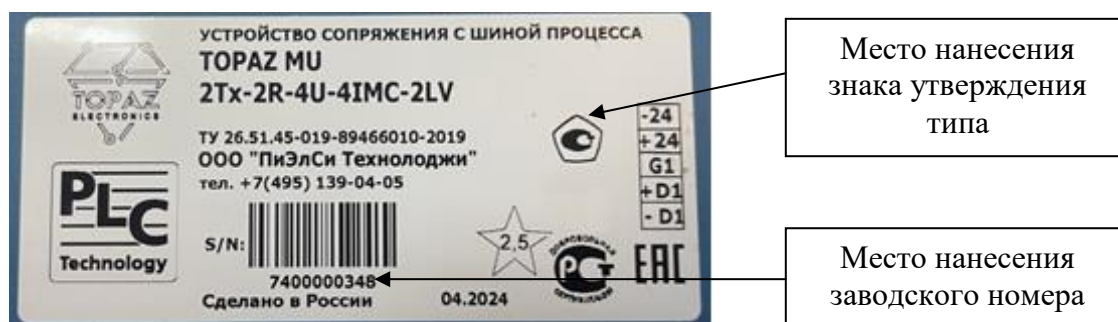
Рисунок 7 – Общий вид маркировочной таблички с указанием места нанесения знака утверждения типа, места нанесения заводского номера
