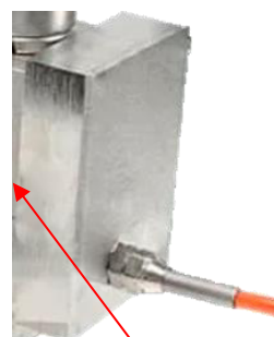
Рисунок 7 – Схема пломбировки приборов весоизмерительных Микросим модификации M0601 от несанкционированного доступа
