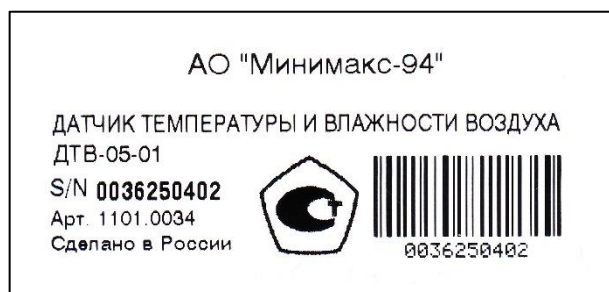
Рисунок 4 – Общий вид маркировки на корпусе датчиков температуры и влажности воздуха ДТВ-05-01
