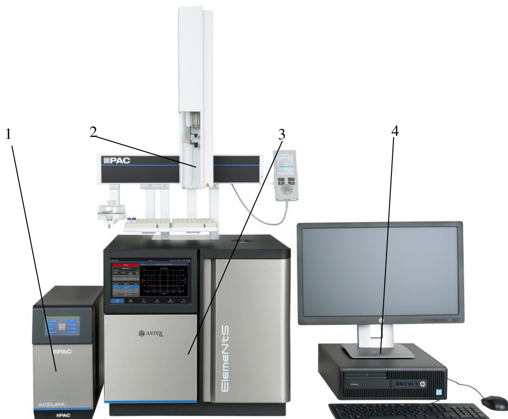
Рисунок 1 – Общий вид анализатора серы и азота ElemeNtS (1 – система ввода газов; 2 - автосамплер для ввода жидких проб; 3 – основной блок анализатора серы и азота ElemeNtS; 4 – персональный компьютер)
