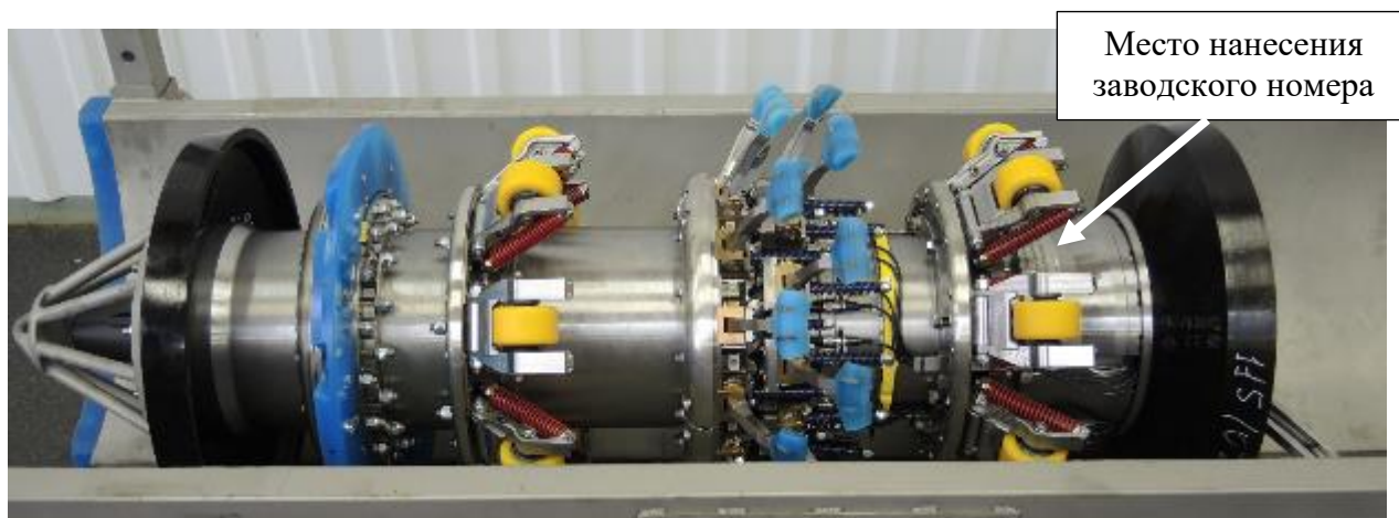
Рисунок 1 – Общий вид внутритрубного дефектоскопа определения положения трубопровода 16-ОПТ.00-01.000
