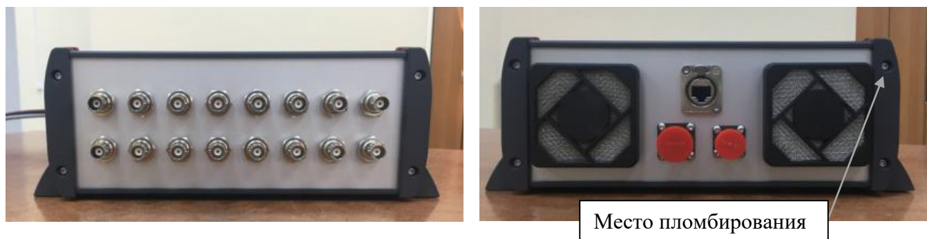
Рисунок 1 – Общий вид дефектоскопов и схема пломбировки от несанкционированного доступа
