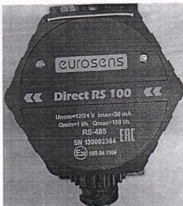
Рисунок 1.1 – Внешний вид счетчиков дизельного топлива EUROSENS Direct Y 100 V (изображение носит иллюстративный характер)
