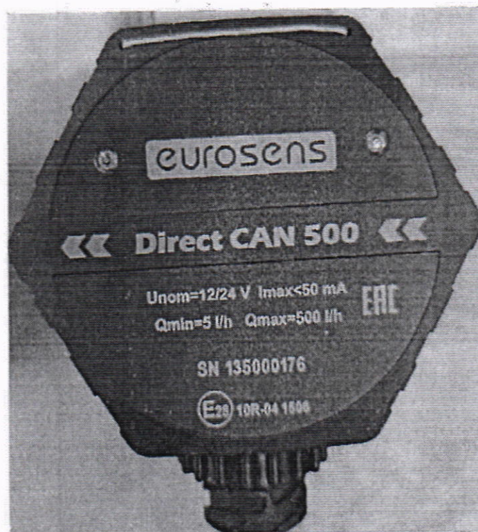
Рисунок 1.3 – Внешний вид счетчиков дизельного топлива EUROSENS Direct Y 500 V (изображение носит иллюстративный характер)
