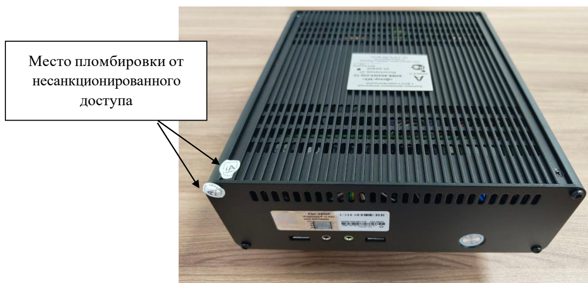
Рисунок 2 – Схема пломбировки комплексов исполнения 01 от несанкционированного доступа
