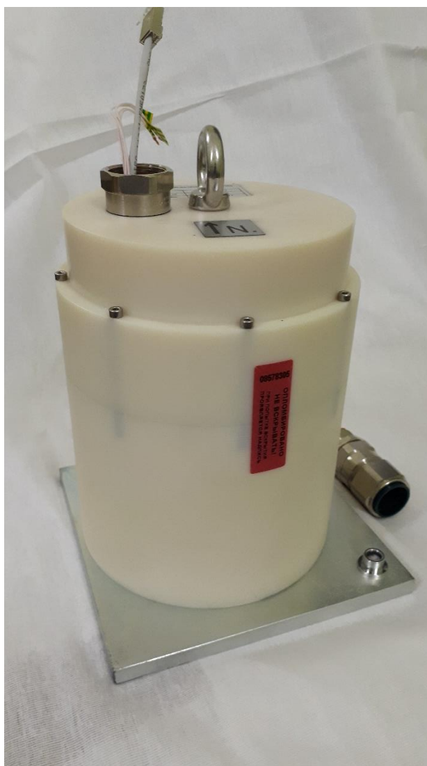
Рисунок 1 – Общий вид станции сейсмической Апатит: а) – модификация Апатит-АН б) – модификации Апатит-OBS
