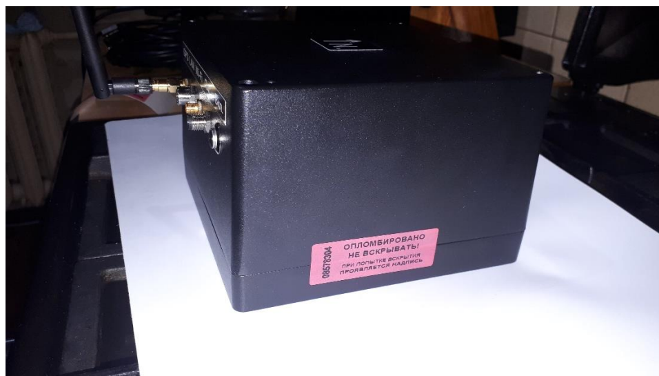
Рисунок 2 – Схема пломбировки станции от несанкционированного доступа
