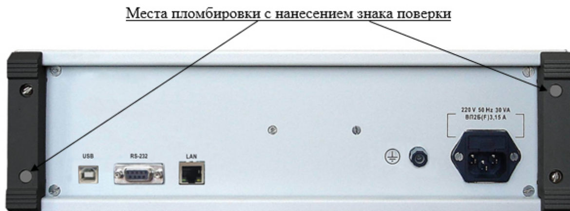
Рисунок 3 – Схема пломбировки от несанкционированного доступа, обозначение мест нанесения знака поверки
