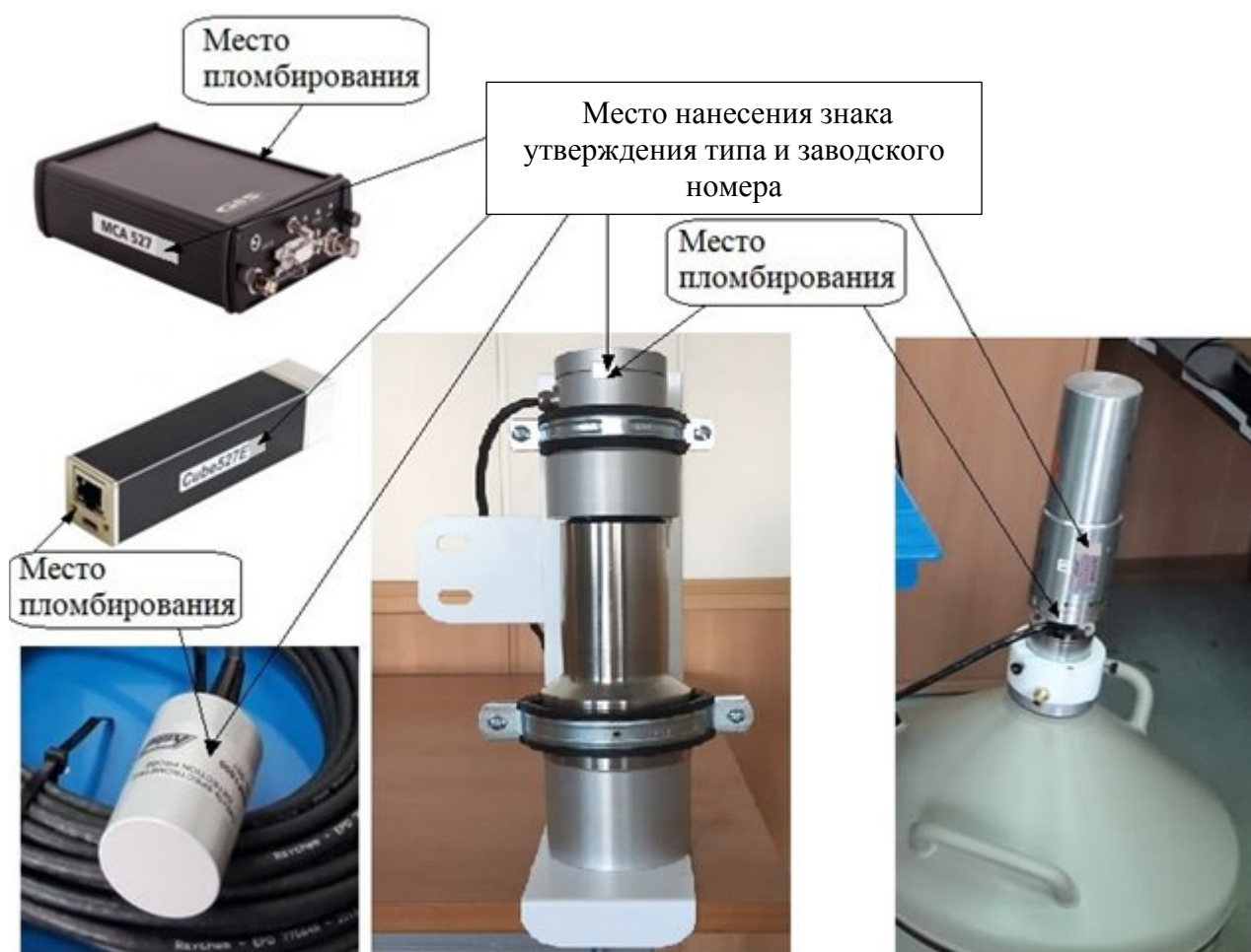
Рисунок 5 – Схема пломбировки от несанкционированного доступа, обозначение места нанесения знака утверждения типа и заводского номера
