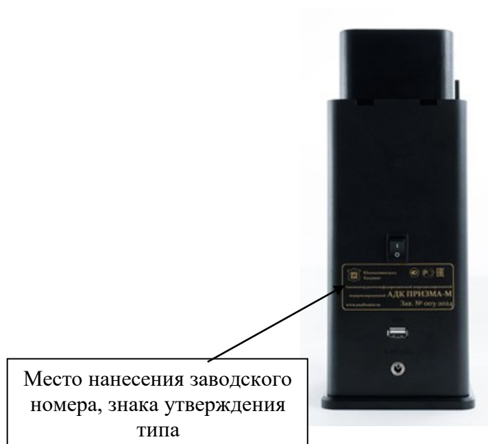
Рисунок 3 – Место нанесения заводского номера, знака утверждения типа на анализаторы
