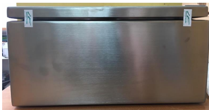
Рисунок 2 – Схема пломбировки от несанкционированного доступа измерительных модулей установок
