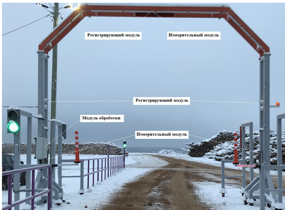
Рисунок 1 – Общий вид установок для измерений габаритных размеров грузов «СканТрек-2100»
