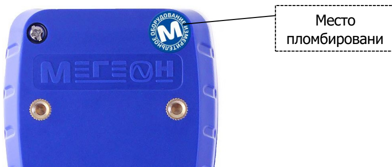
Р и с у н о к 3 – Схема пломбирования от несанкционированного доступа
