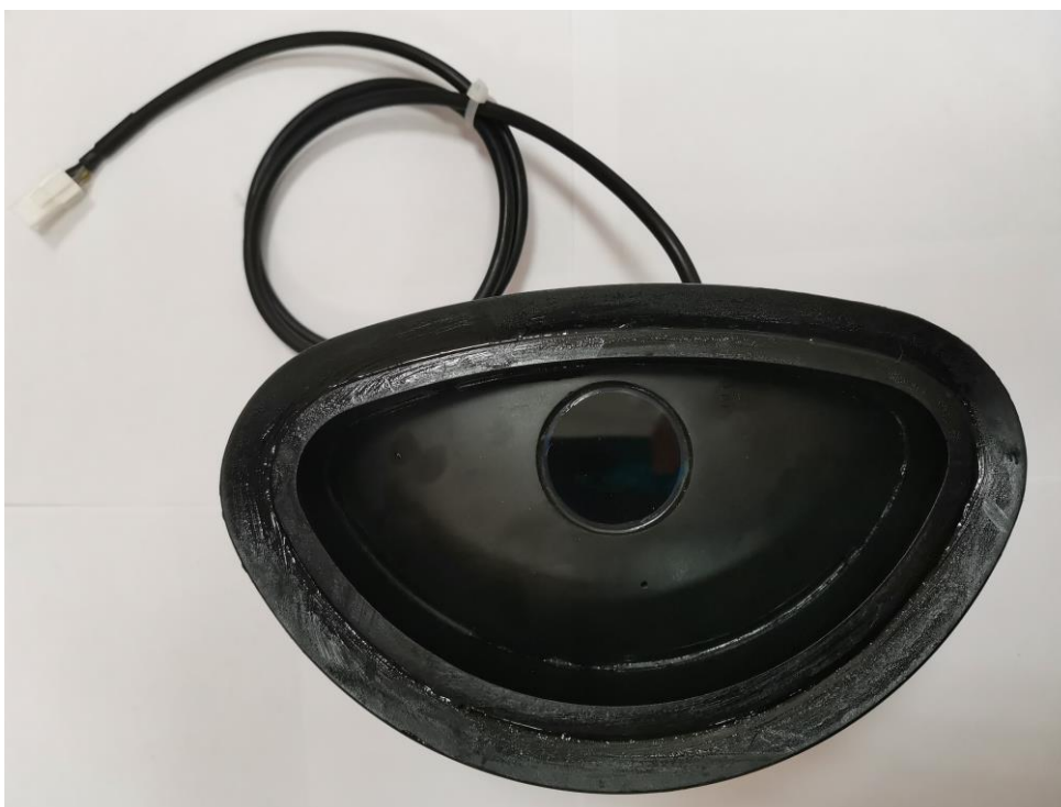
Рисунок 3 – Общий вид блока с устройством для крепления на стекло транспортного средства
