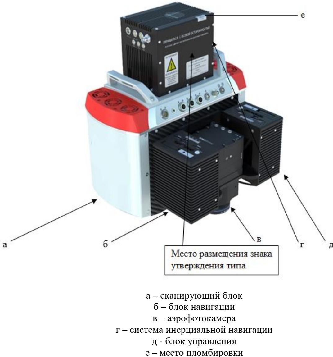
Рисунок 1 – Общий вид системы с указанием места нанесения знака утверждения типа
