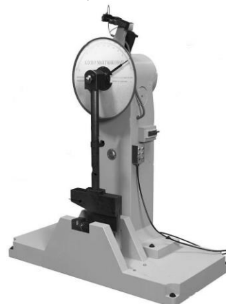
Рисунок 4 – Общий вид копров маятниковых ГОСТ серии МИК модификации МИК-150 (300; 450; 750; 900). 2-1.1.V
