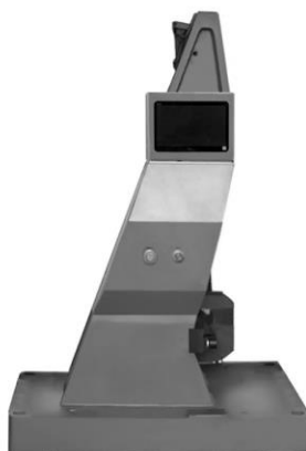
Рисунок 5 – Общий вид копров маятниковых ГОСТ серии МИК модификации МИК-150 (300; 450; 750; 900). 2-2.2.V
